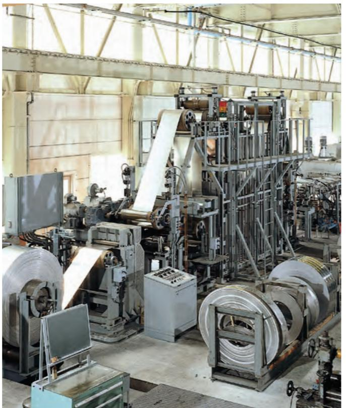
ステンレス帶鋼用光輝焼鈍炉
