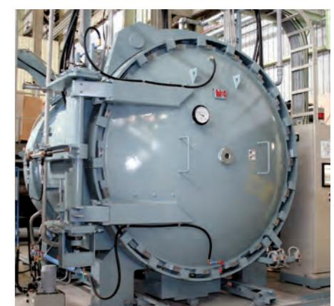
パイプ用真空熱処理炉
