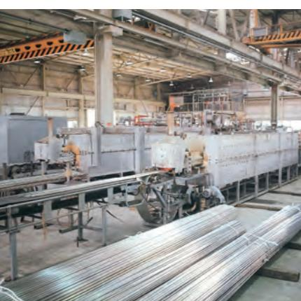
ステンレス管用光輝焼鈍炉
