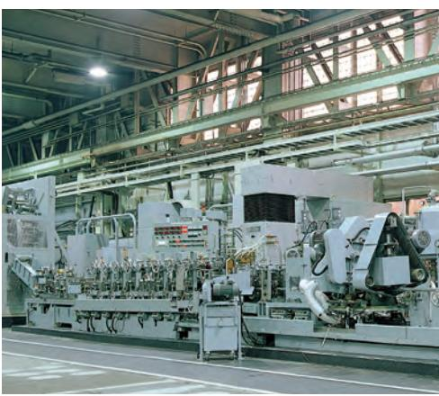
ステンレス管高周波溶接造管機
