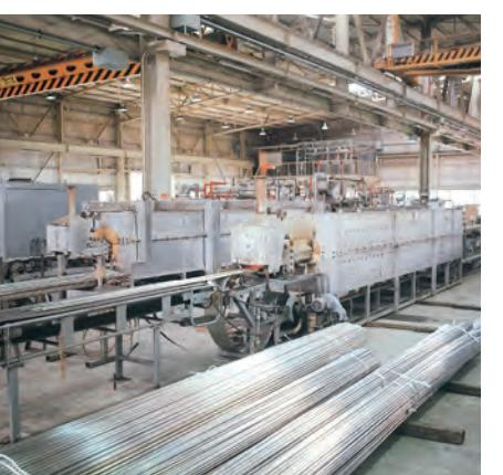
ステンレス管用光輝焼鈍炉
