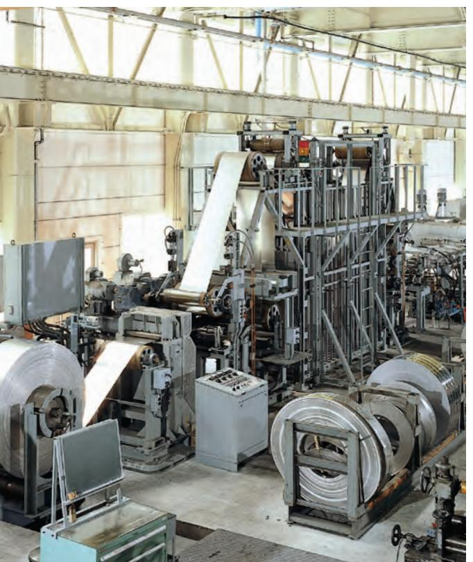
ステンレス帶鋼用光輝焼鈍炉
