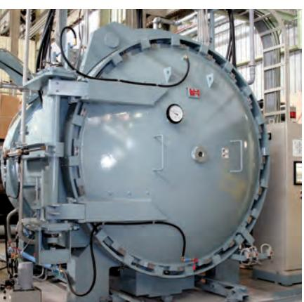
パイプ用真空熱処理炉
