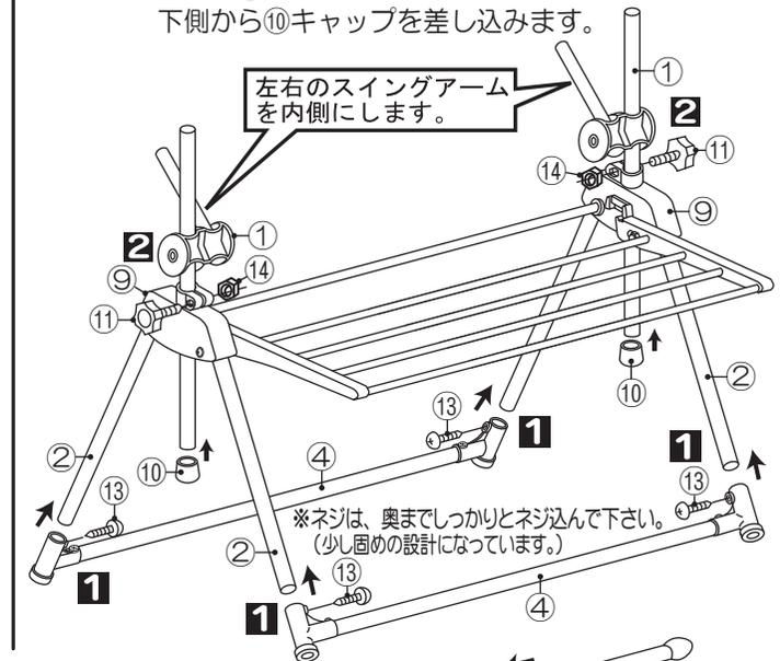
**3 1** ①上支柱のスイングアームに⑦スイングパイプを奥までしっかりと差し込み、⑬ネジ（小）で固定します。
