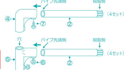
〈ご注意〉必ず先に、②伸縮パイプに④L型ジョイントを取り付けて下さい。
