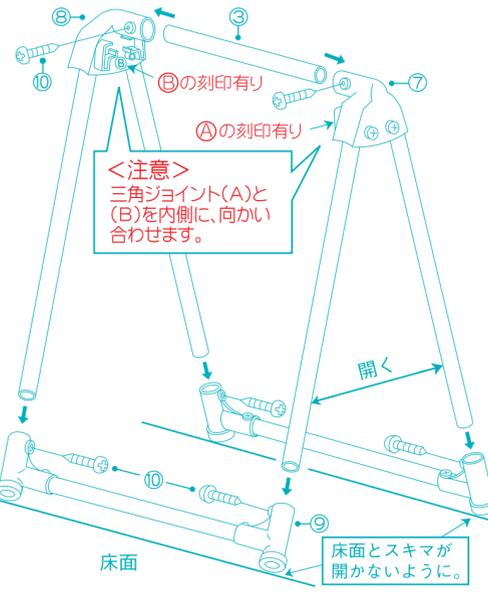
支柱を最大に開いた状態で床面に4カ所全ての脚が着き、ガタつきやねじれの無い事を確認してから、ネジを締めして下さい。
