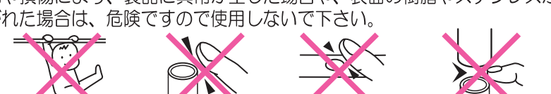
ぶら下がらないこと パイプの先端危険 穴部分危険 差し込み時、指づめ注意
