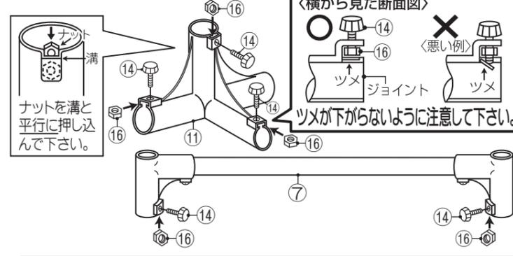
**2** 図のように、⑪ジョイントに⑧脚連結パイプと⑩倒れ止めパイプを差し込み、⑩倒れ止めパイプの中央の位置で⑭化粧ネジで仮止めます。
