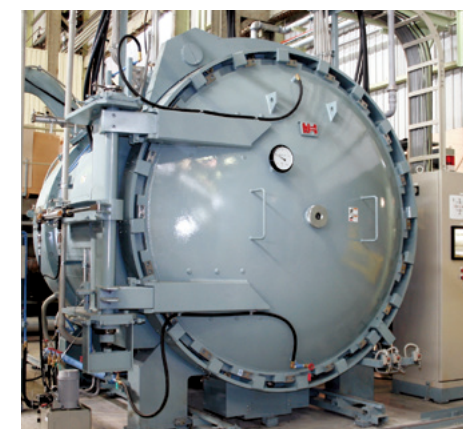
パイプ用真空熱処理炉
