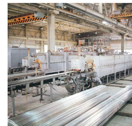
ステンレス管用光輝焼鈍炉
