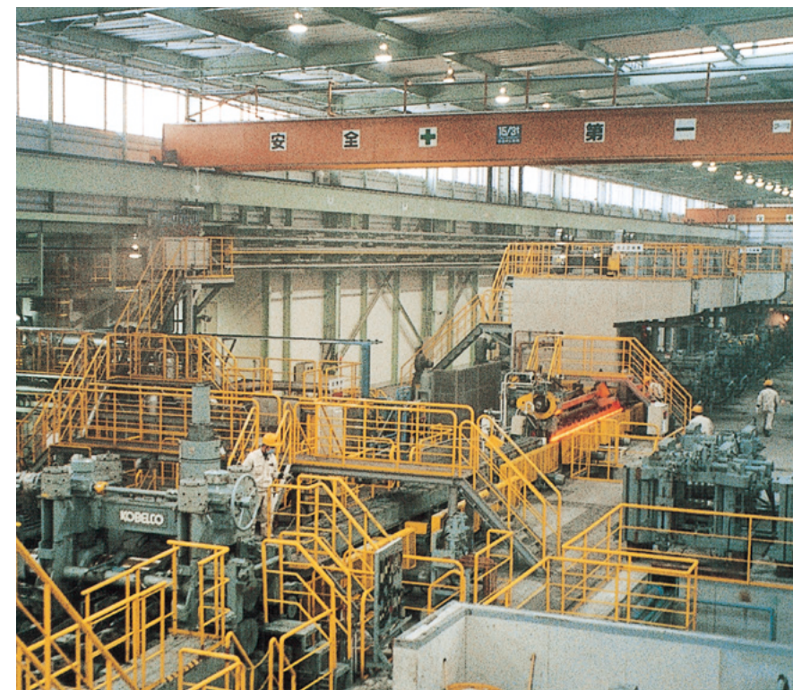
ステンレス条鋼用熱間圧延ライン（茨城工場）
