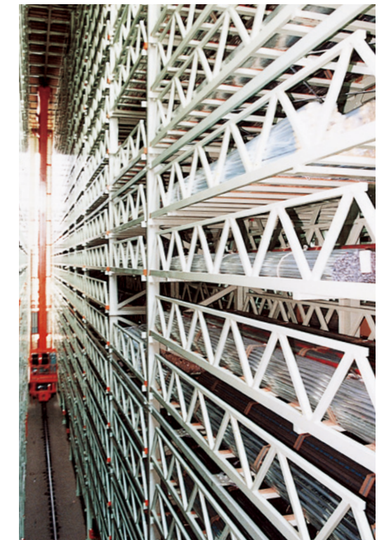
ステンレス管用立体倉庫
