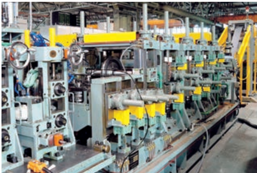
FFX高周波造管機（平成27年3月より稼働開始）
